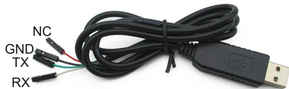
Rys.2 - Opis wyprowadzeń z typowego konwertera USB-UART/TTL/5V. Podłączenie do złącza J1: GND → GND, TX → RX, RX → TX.
